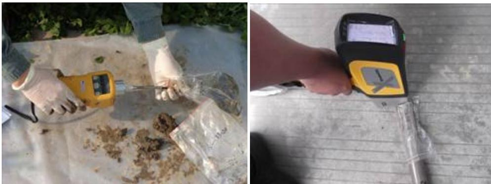
图 5.2-2 现场 PID 与 XRF 检测
