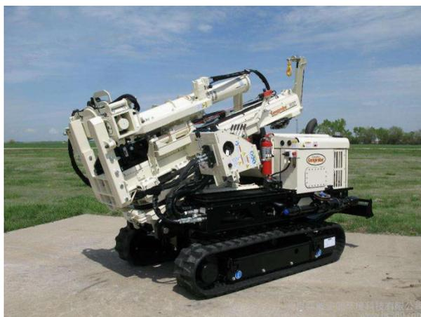
图 5.2-1 7822DT 型 Geoprobe 钻机
